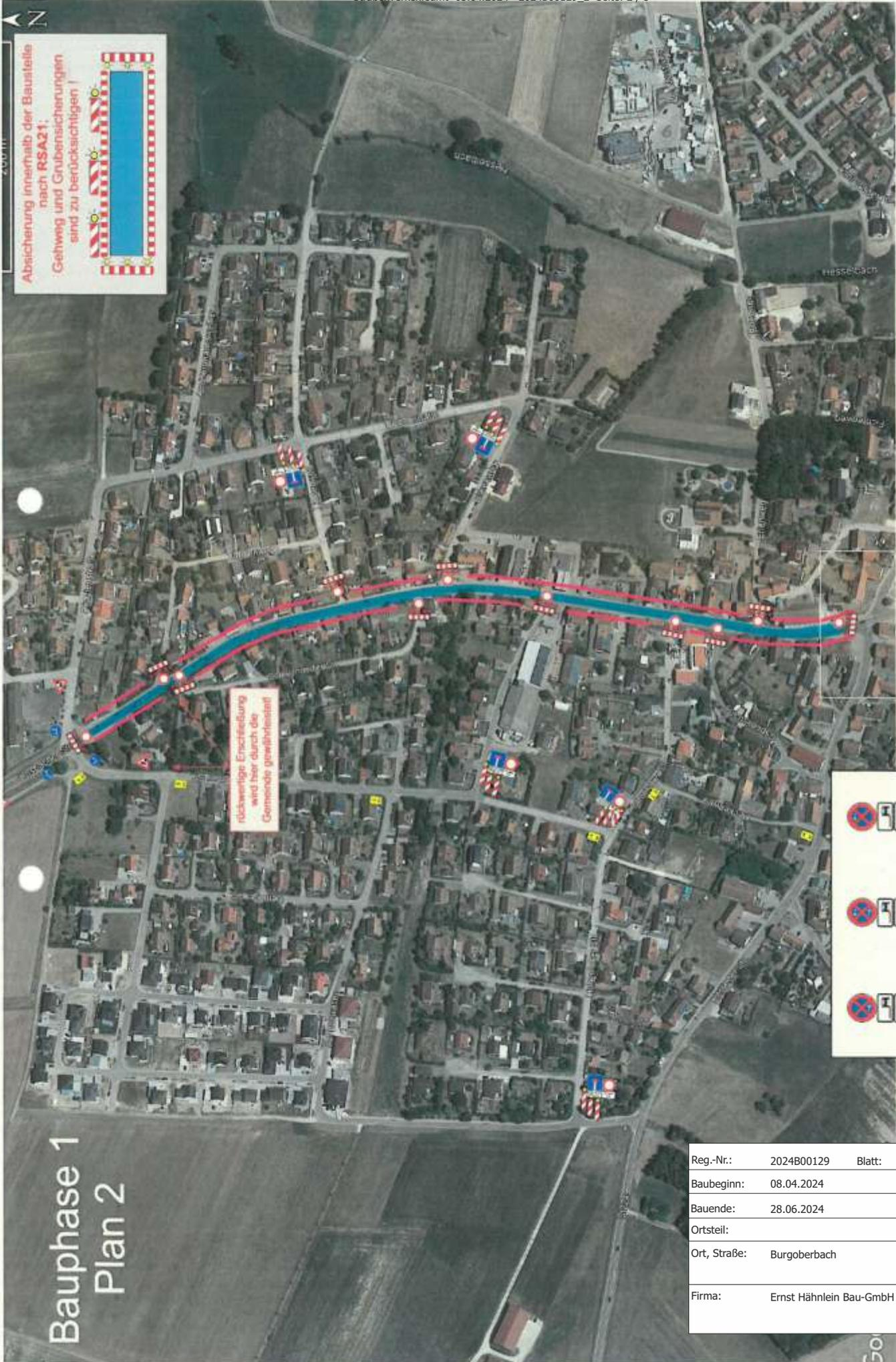
Absicherung innerhalb der Baustelle nach RSA21: Gehweg und Grubensicherungen sind zu berücksichtigen!
