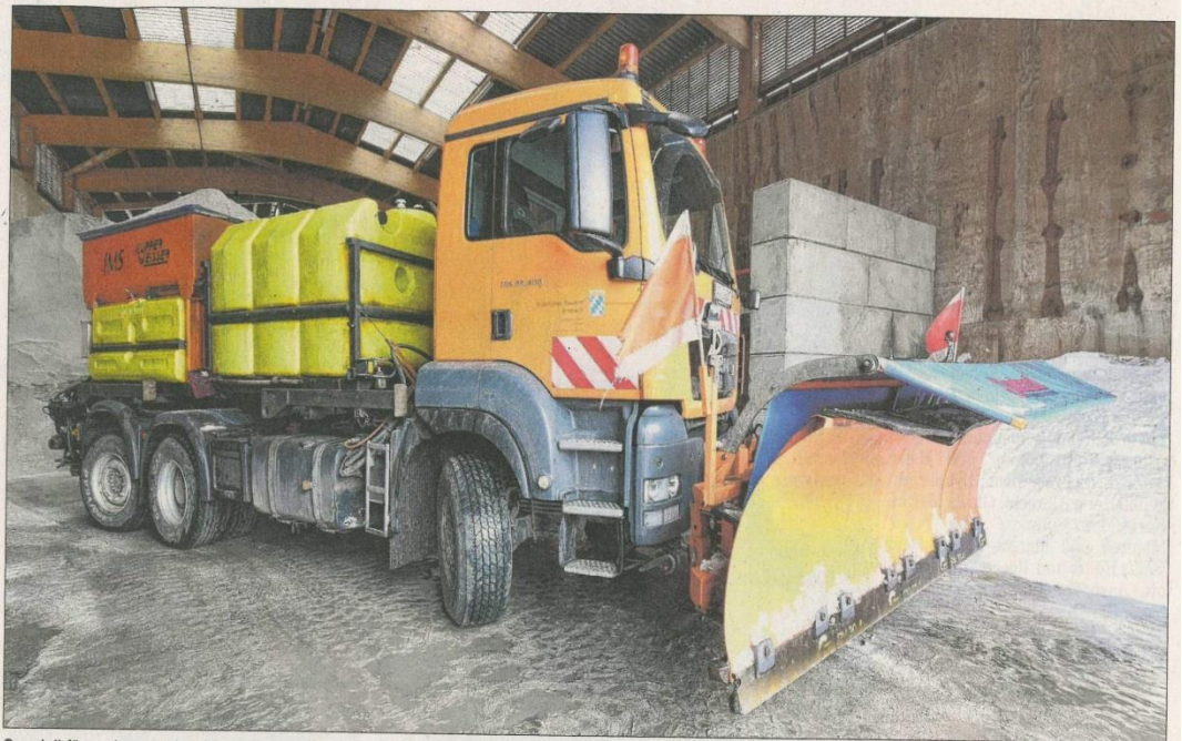
Speziell für vorbeugendes Streuen ausgerüstet ist ein neuer Fahrzeugtyp des Staatlichen Bauamts, der auch in Ansbach-Brodswinden stationiert ist. Die Besonderheit sind große gelbe Tanks für Sole, welche die Bildung von Glatteis verhindert. Auch für Feuchtwangen und Rothenburg-Uffenheim wurden nun solche „Kombi-Streuer“ angeschafft.
